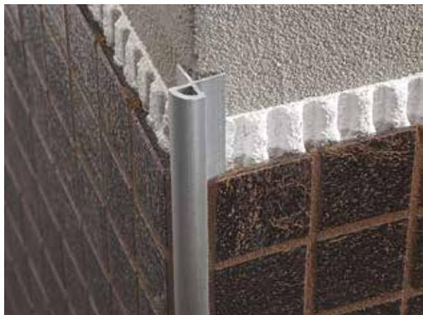
Perfil patentado comodín con un innovador concepto de producción en "X" para una mejor fijación mecánica de las baldosas de mosaico vítreo. Adecuado para la protección de las esquinas y los peldaños, destaca una parte visible redondeada y simétrica. La altura fija de 4,4 mm lo hace ideal para la colocación de mosaicos de vidrio clásicos.
